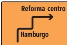
**DIAGRAMÁTICA DE DESVÍO:** Indica a los conductores de vehículos, mediante un esquema, los puntos de decisión en los que se debe realizar una maniobra para librar un zona de obra y poder regresar a la ruta principal.
