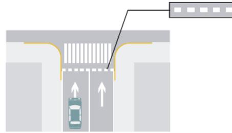
**RAYA DE CEDA EL PASO:** Indica a los conductores de vehículos el lugar en el que deben detenerse debido a una señal de ceda el paso.
