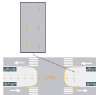
**IDENTIFICACIÓN DE INSTALACIONES SUBTERRÁNEAS:** Indica el trazo de las instalaciones subterráneas con objeto de evitar que, cuando se realicen trabajos de construcción de nuevas instalaciones o labores
