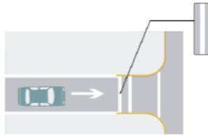
**RAYA DE ALTO:** Indica a los conductores de vehículos el lugar en el que deben detenerse debido a una señal de alto, semáforo o punto de control en el camino.
