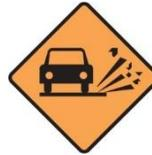
**MATERIAL SUELTO:** Indica a los conductores de vehículos la proximidad de un tramo en el cual el pavimento presenta gravilla suelta que puede ser proyectada por el paso de vehículos o material fino que impida el control del vehículo al frenar.
