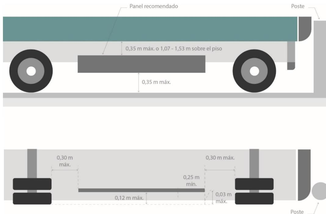
La parte inferior del salvaguarda debe estar a una altura de 0.35 m sobre la superficie de rodadura y la parte superior a 0.35 m de la plataforma del camión. Si no es posible cumplir con la cota en la
